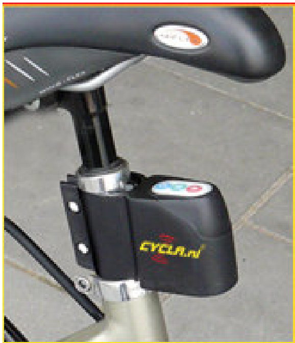
Foto 53. Raamile paigaldatud alarmlukk.
